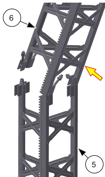
Abb. 36: Linkes Mastteil montieren
